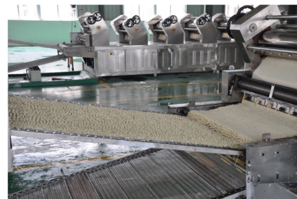
压延输送 pressing & conveying
